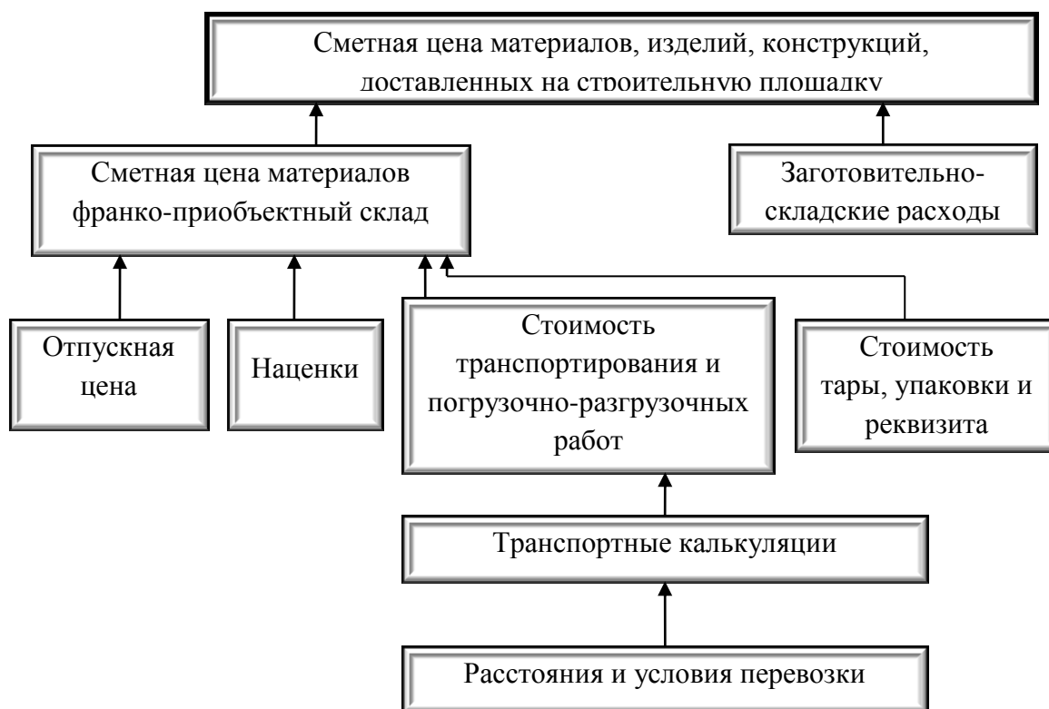
Рисунок 1. - Схема определения сметной цены материалов, изделий и конструкций
