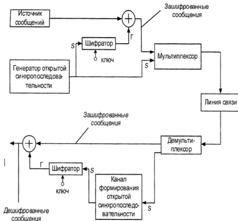
Рисунок 1 – Функциональная схема передачи сообщений с криптозащитой по линии связи: S – двоичная синхропоследовательность, Г – двоичная последовательность с выхода шифратора.
