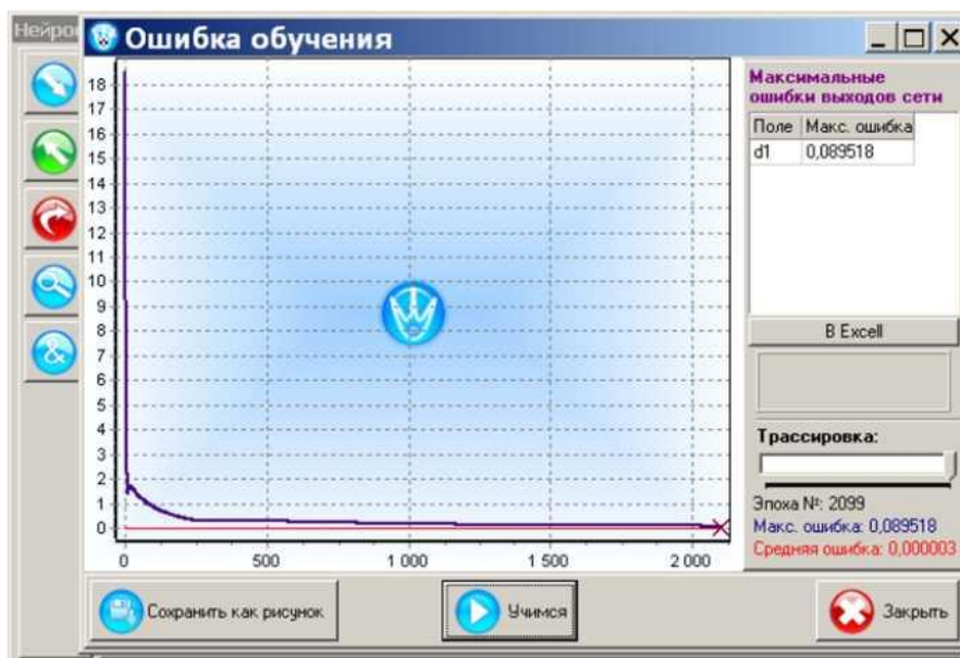
Рис. 1.7. Графическое отображение процесса обучения сети с семью нейронами скрытого слоя
