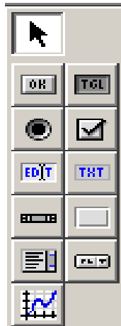
Рисунок 2 - Панель инструментов для добавления элементов интерфейса
