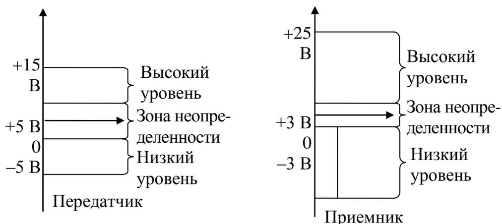
Рис. 8.11. Уровни сигналов RS-232C на передающем и принимающем концах линии связи
