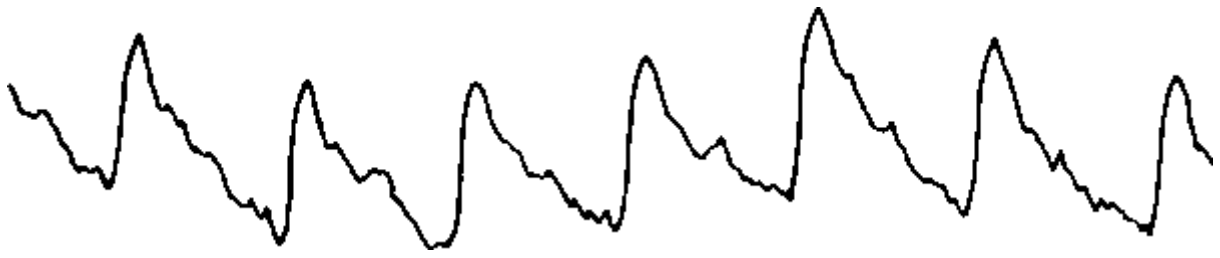
Рисунок 4.1 – Типичный фотоплетизмографический сигнал
