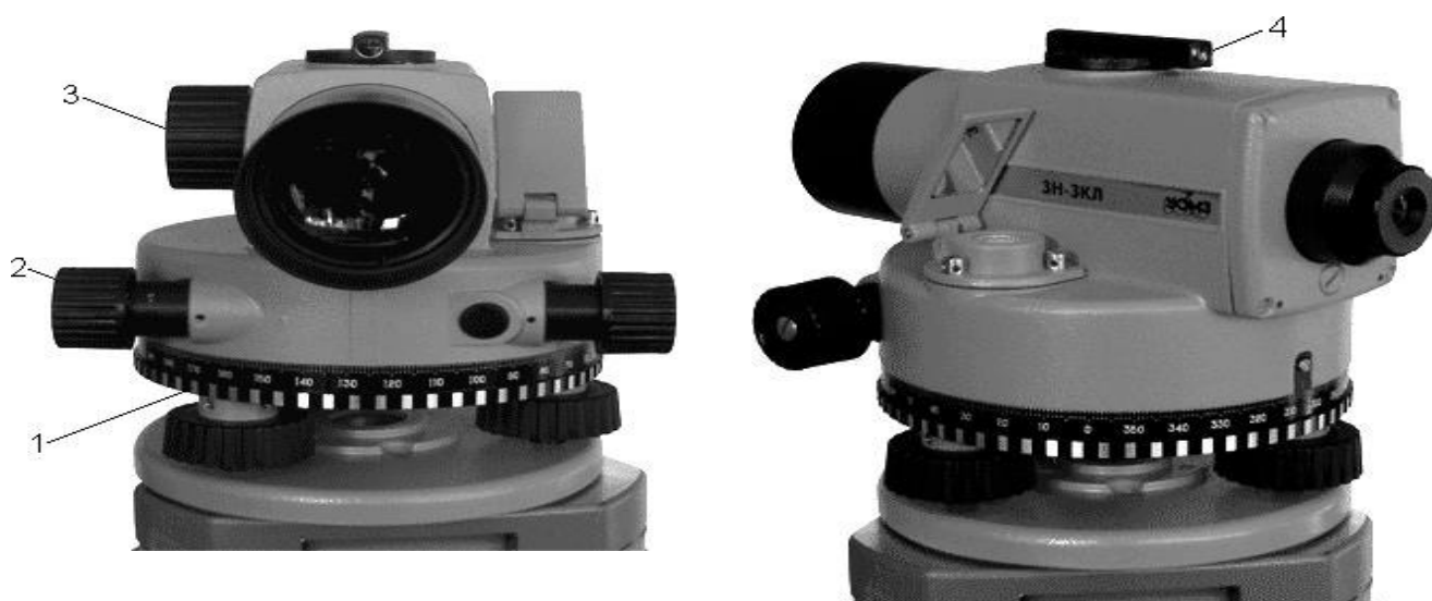
Рисунок 2. Точный нивелир 3Н-3КЛ с компенсатором и лимбом: 1 – лимб; 2 – наводящий винт; 3 – кремальера; 4 – визир
