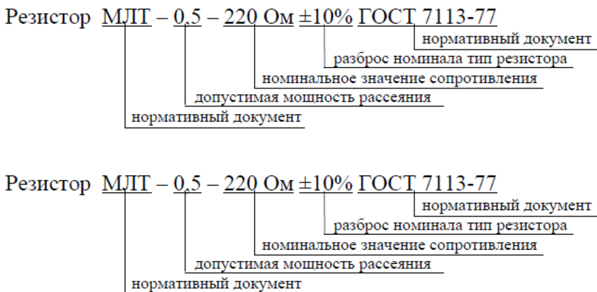
Рисунок 4 - Пример полной записи обозначений для резистора и конденсатора
