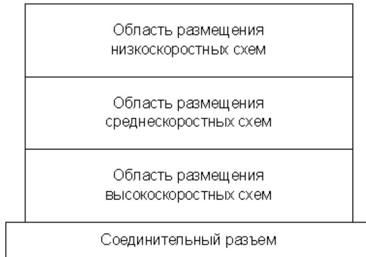
**Рисунок 7- Области размещения микросхем с различным быстродействием
