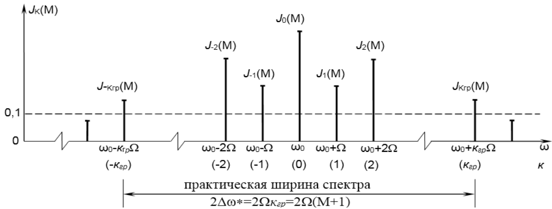
Рисунок 3 – К определению практической ширины спектра при угловой модуляции
