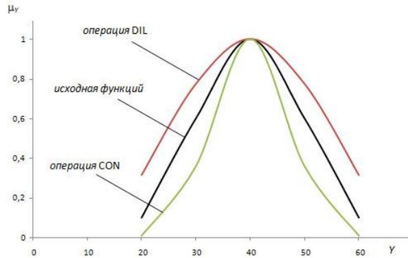
Рис. 12 Операторы растяжения и концентрации
