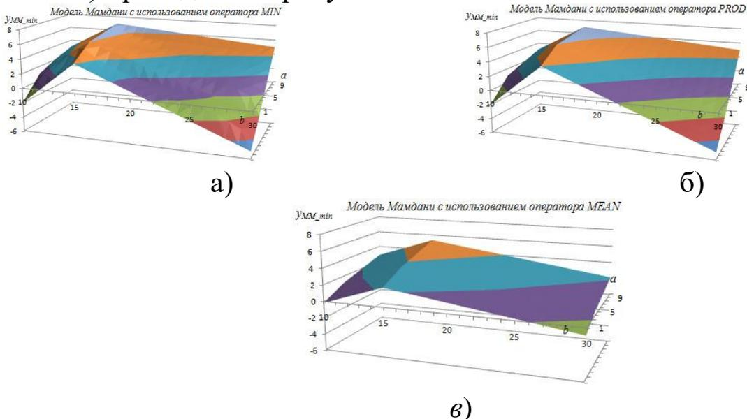
Рис. 18. Поверхность отклика нечеткой MISO-системы для модели Мамдани: *a* – с использованием оператора MIN; *б* – с использованием оператора PROD; *в* – с использованием оператора MEAN.
