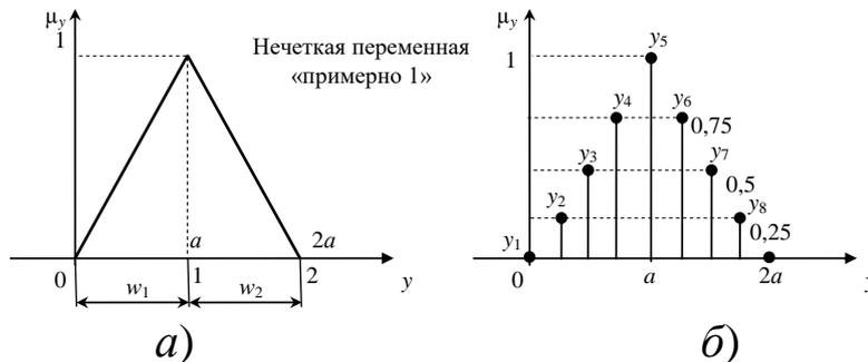
Рис. 6. Функции принадлежности нечеткой переменной «примерно один»: а – непрерывный вид ФП; б – дискретный вид ФП
