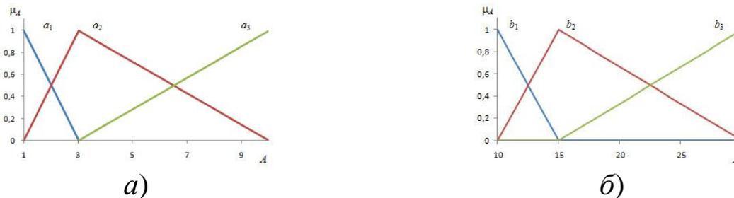
Рис. 18. Модель Мамдани для MISO-системы:  $a$  – входная переменная  $A$ ;  $b$  – входная переменная  $B$ .
