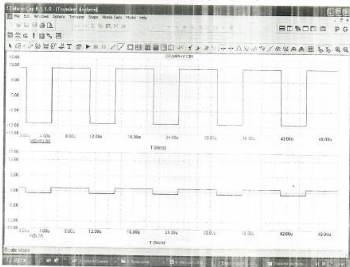
Рис. 6.4. Формы напряжений на входе и выходе неинвертирующего усилителя на основе ОУ
