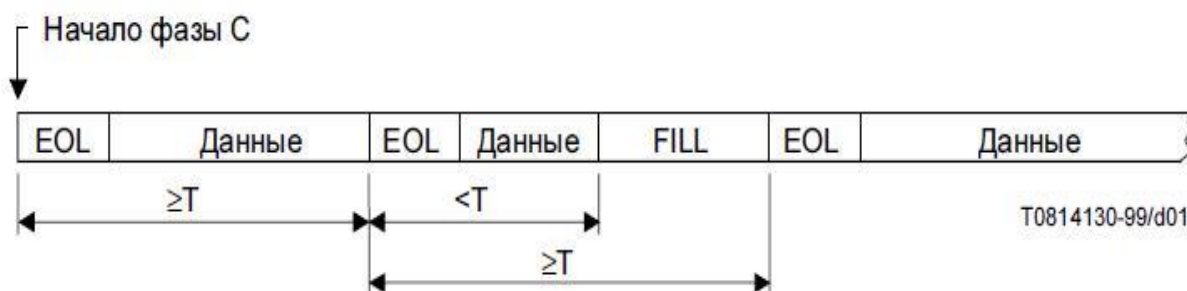
Рисунок П 6.1. Структура двоично-кодированного факсимильного сообщения (начало передачи текущей страницы; T – минимально-допустимое время передачи полной кодированной строки развертки)
