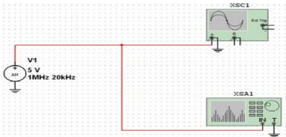
Рисунок 11 – Схема экспериментальной установки V1 – амплитудный модулятор, XSA1 – анализатор спектра, XSC1 – осциллограф
