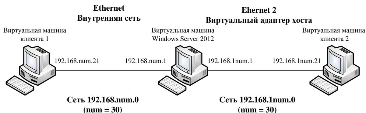
Рис. 1. Схема сети с маршрутизатором
