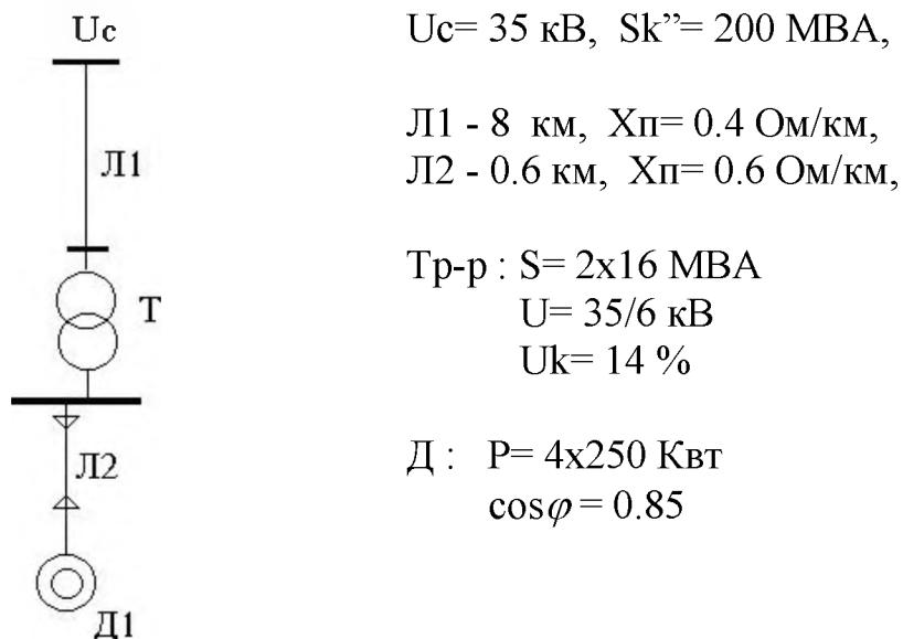
21. Построить угловую характеристику мощности электропередачи.
