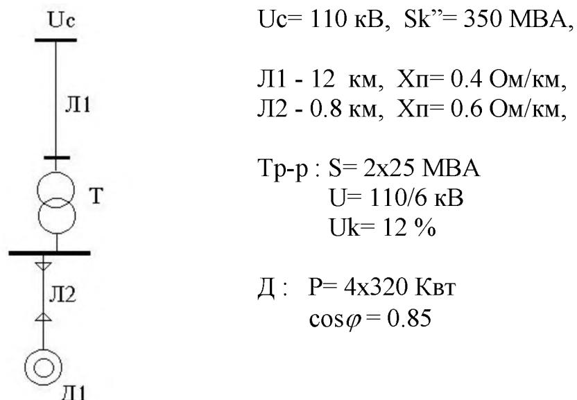
17. Построить угловую характеристику мощности электропередачи.
