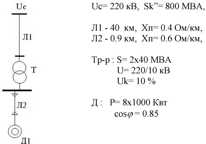
19. Построить угловую характеристику мощности электропередачи.
