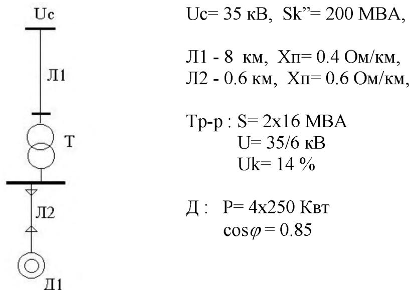
15. Построить угловую характеристику мощности электропередачи.
