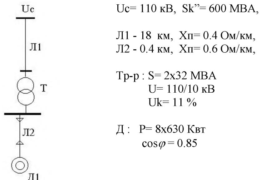
23. Построить угловую характеристику мощности электропередачи.
