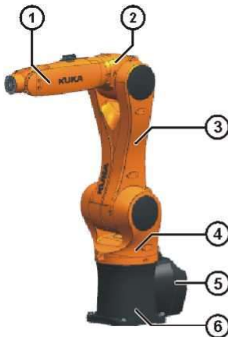
Рис. 2.1 Устройство манипулятора KR AGILUS
