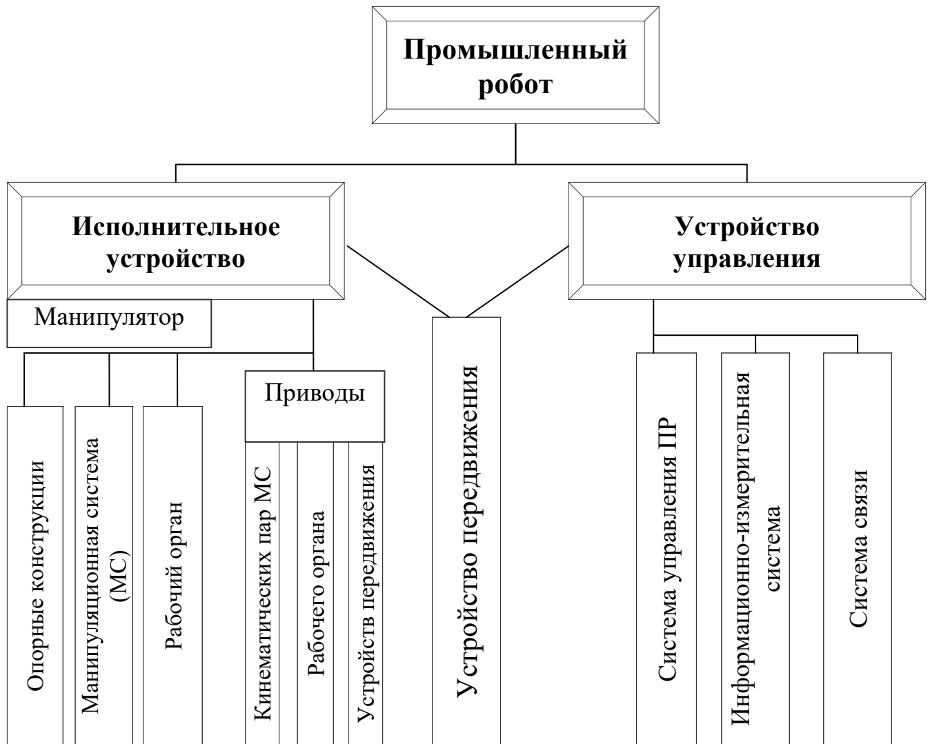
Рис.1. Составные элементы промышленного робота
