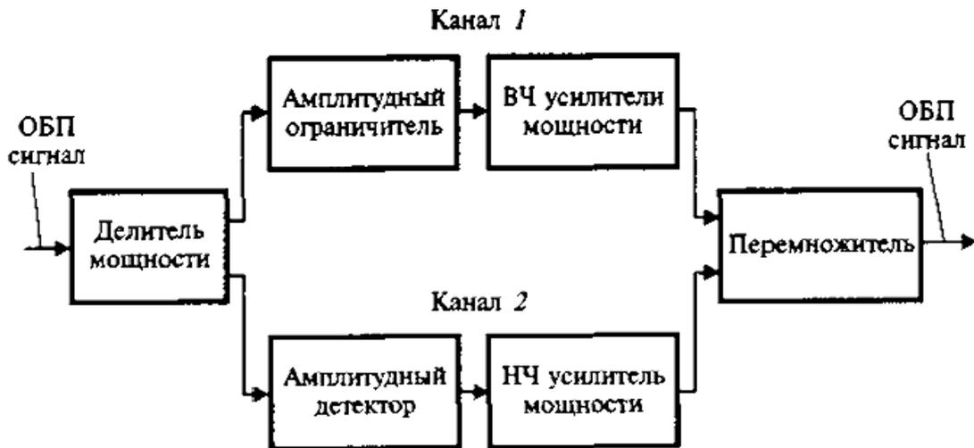
Рисунок 8 – Схема двухканального усилителя для отдельного усиления сигналов с фазовой и амплитудной модуляцией
