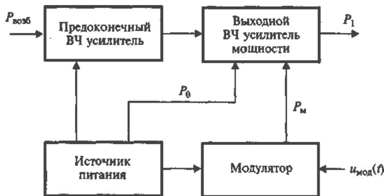
Рисунок 3 – Структурная схема усилительного тракта РПДУ
