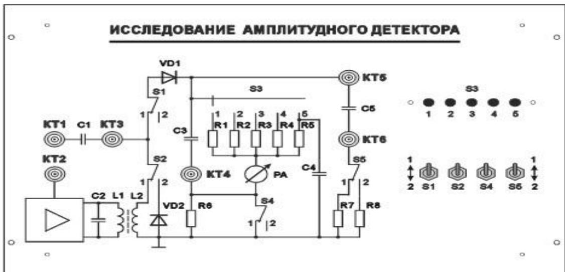
Рисунок 1 – Лицевая панель сменного блока «Исследование амплитудного детектора»
