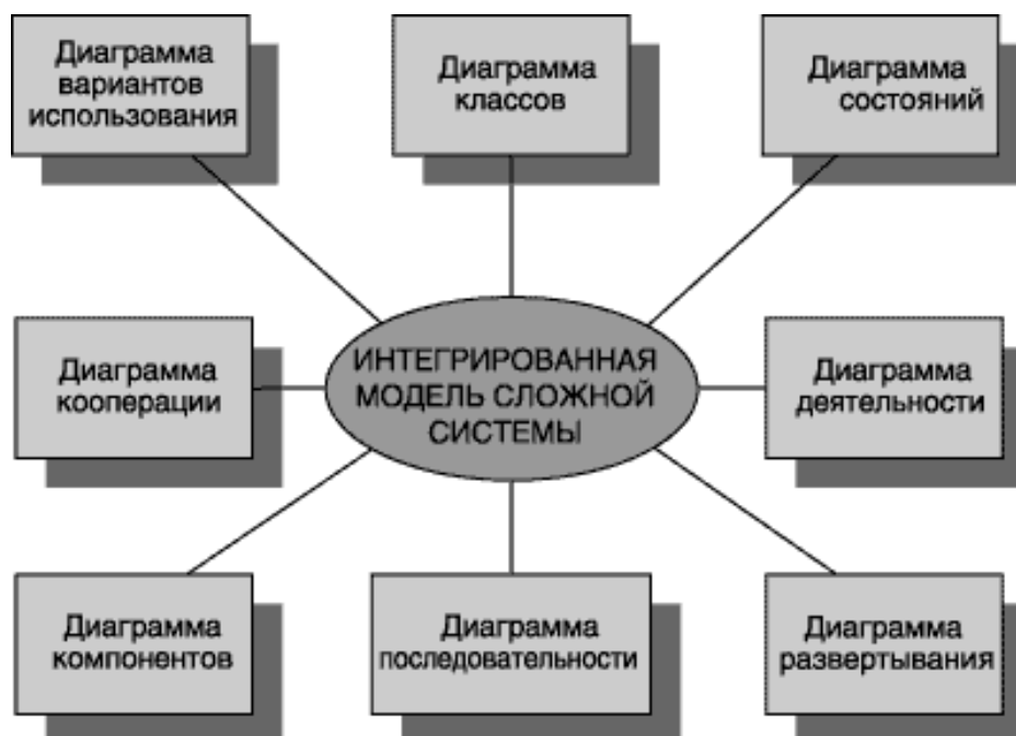
Рисунок 3.1 – Интегрированная модель сложной системы в нотации UML [11, с. 8]
