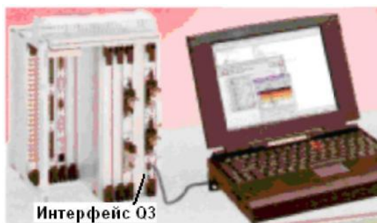
Рисунок 6 – Пример подключения терминала управления 1320СТ к мультиплексору SDH через интерфейс Q3
