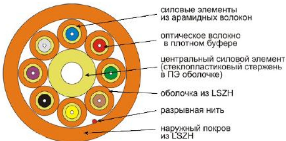
Рисунок 4 - Пример конструкции развивного оптического кабеля
