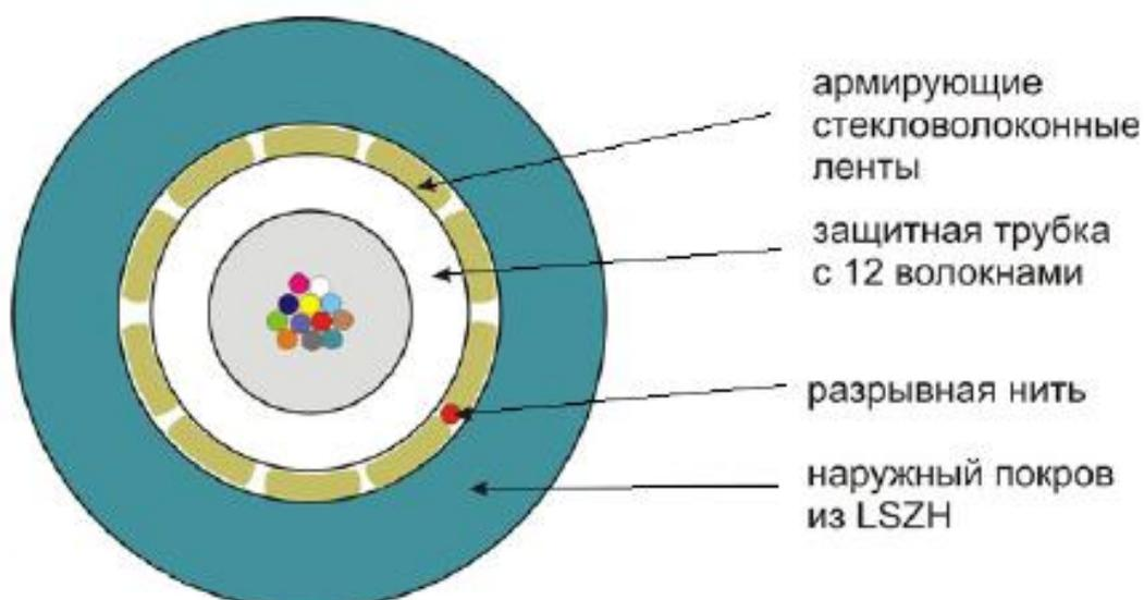
Рисунок 2б - Пример конструкции ОК для прокладки в
