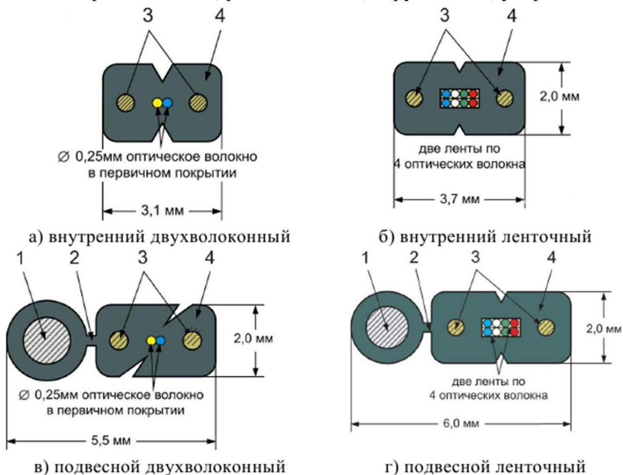
Рисунок 5 - Конструкции оптических кабелей для сетей FTTx типа «двойной квадрат»: 1 – несущий стальной провод 1,2мм в диаметре; 2 – перемычка; 3 – арамид диаметром 0,5мм; 4 – полиэтилен или LSZH оболочка
