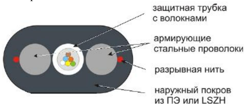
Рисунок 2в - Пример конструкции ОК для прокладки внутри
