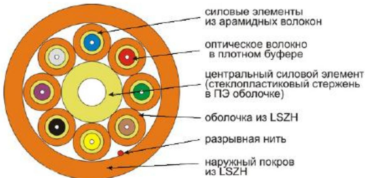
Рисунок 4 - Пример конструкции развивного оптического кабеля
