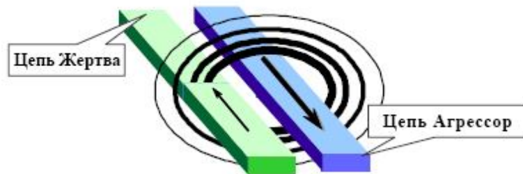
Рисунок 4 – Наводка в цепи агрессоре на цепь жертвы.
