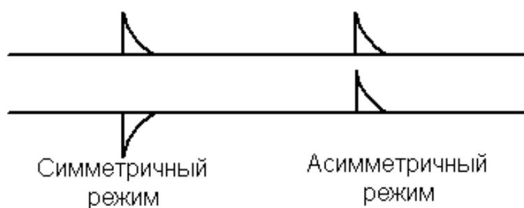
Рисунок 1 – Помехи, образованные симметричным и асимметричным типами токов.
