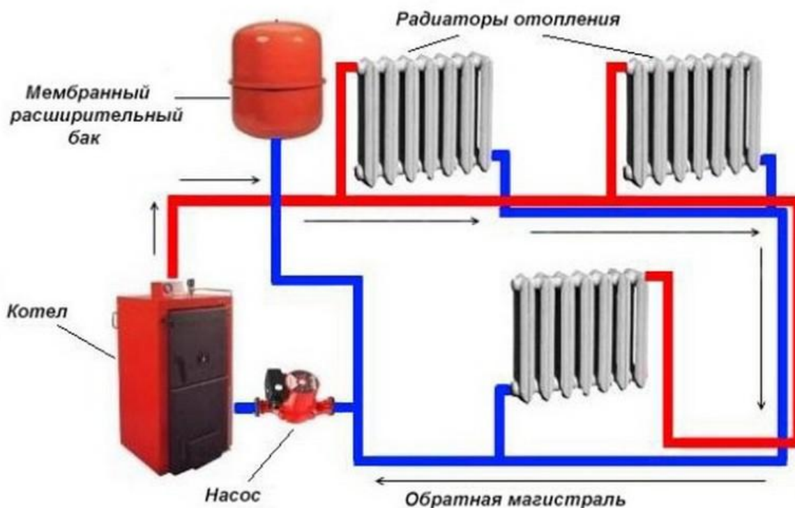
Рис.2 – Система отопления с искусственной циркуляцией
