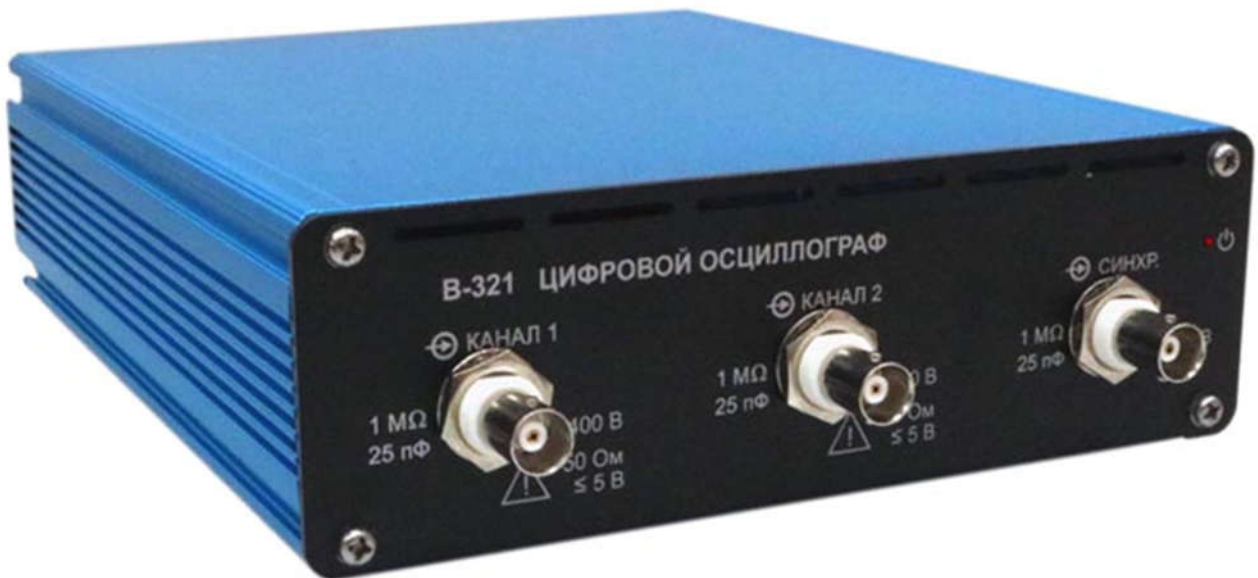
Рисунок 4.2 – Цифровой осциллограф с интерфейсами Ethernet и USB 3.0, с частотой дискретизации в режиме реального времени 1 ГГц и 20 ГГц в стробоскопическом режиме
