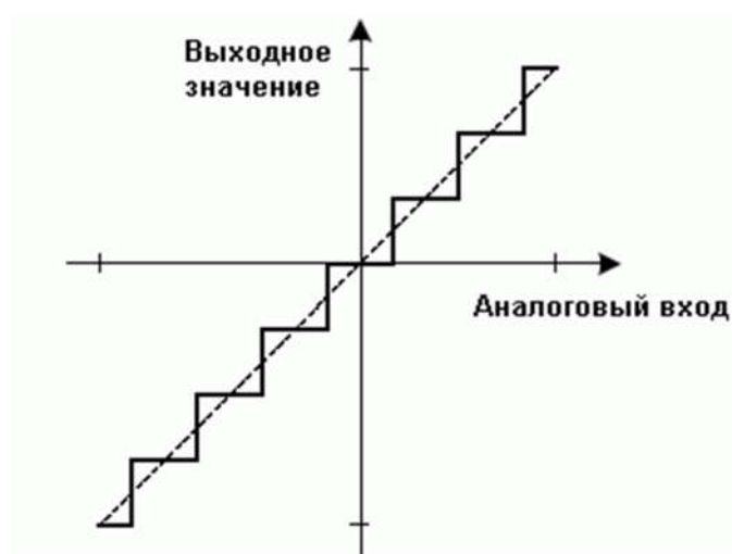
Рисунок 3.2 - Передаточная функция 3-разрядного совершенного АЦП
