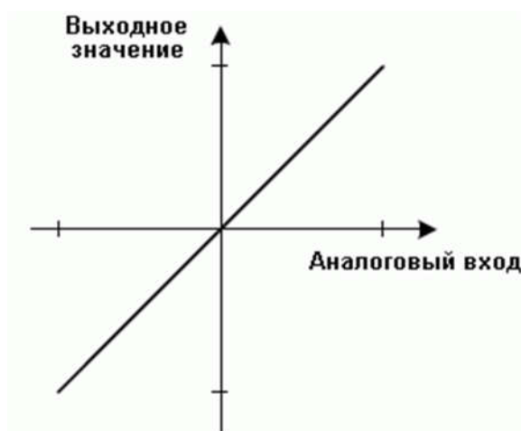
Рисунок 3.1 - Передаточная функция идеального АЦП
