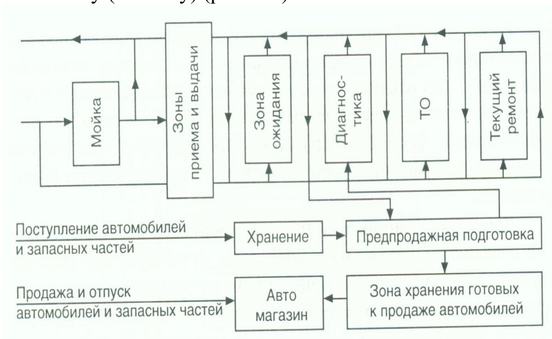
Рис. 4.3. Схема технологического процесса на СТОА
