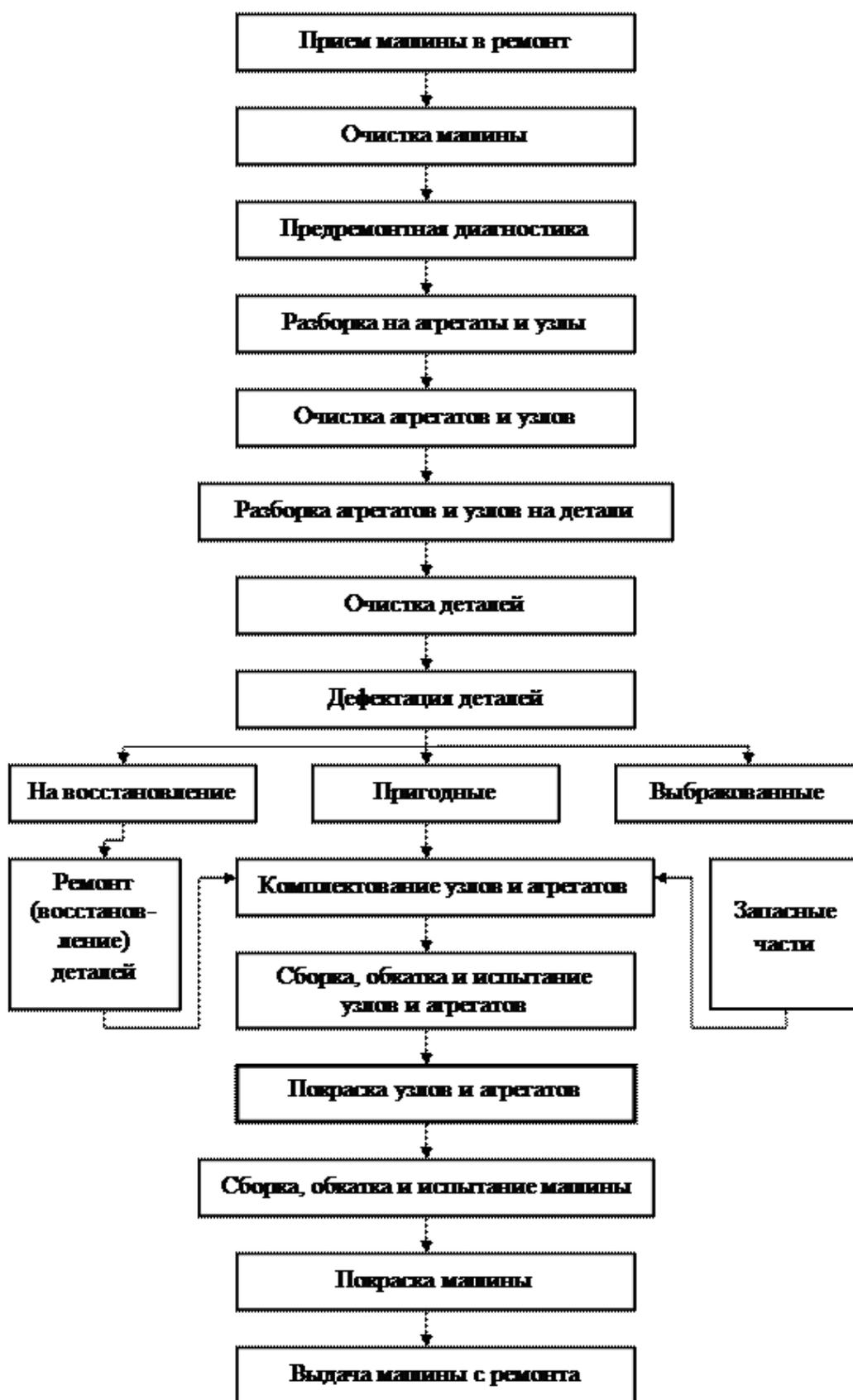
Рисунок 4 – Технологические процесс обслуживания автомобилей
