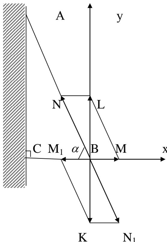
Рис. 1. Разложение веса груза по направлениям стержней
