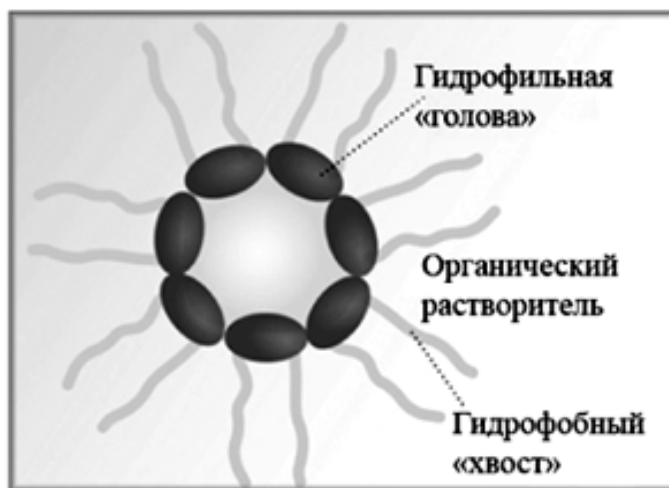
Рисунок 4 - Схема обращенной мицеллы, образованной бромидом тетраоктиламмония в растворе толуола
