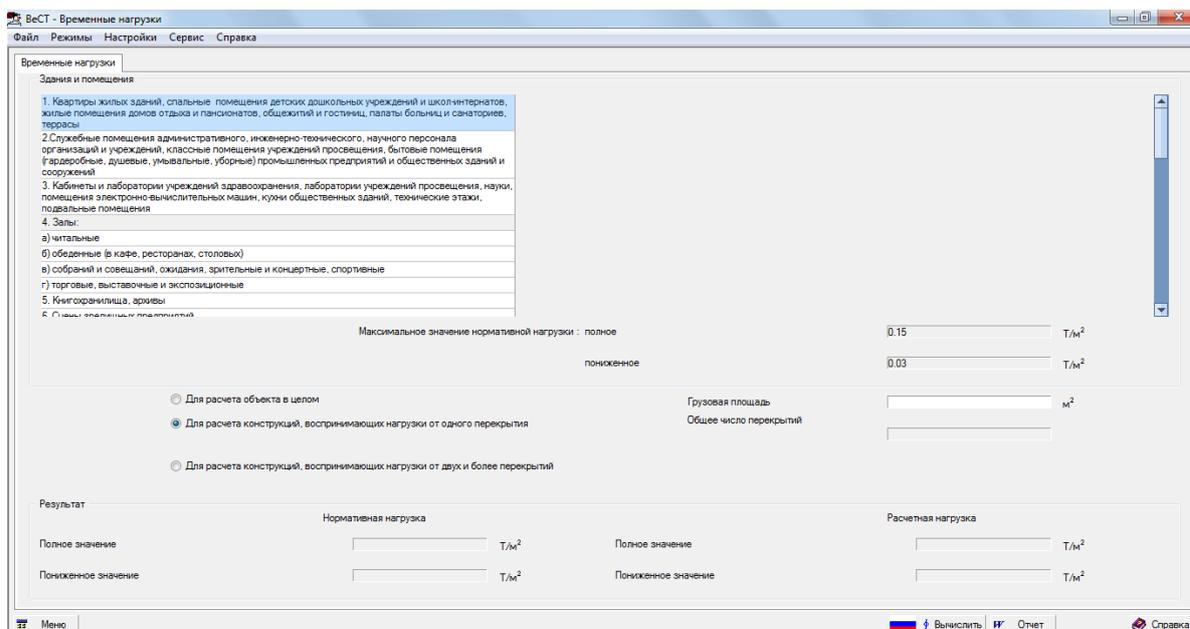
Рисунок 3.3 – Диалоговое окно ВЕСТ для определения временных нагрузок
