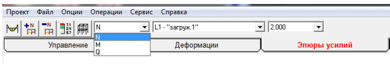
Рисунок 2.18 – Панель SCAD для выбора отображаемых внутренних усилий
