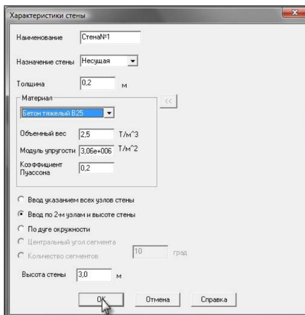
Рисунок 4.12 – Диалоговое окно Форум для назначения параметров стены
