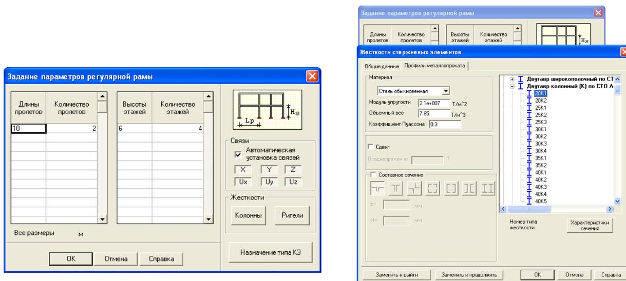
Рисунок 3.8 – Диалоговое окно SCAD для назначения параметров рамы
