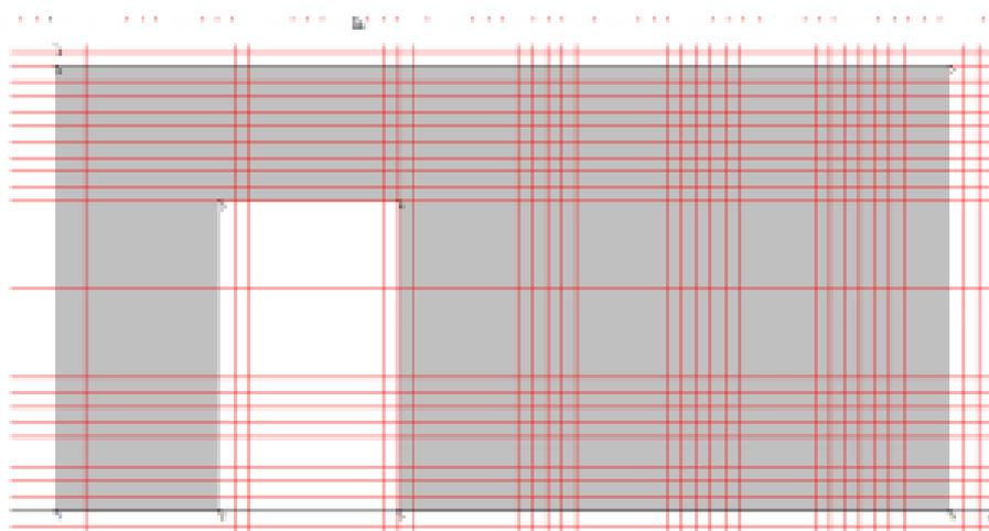
Рисунок 4.19 – Построение оконных отверстий в программе Консул
