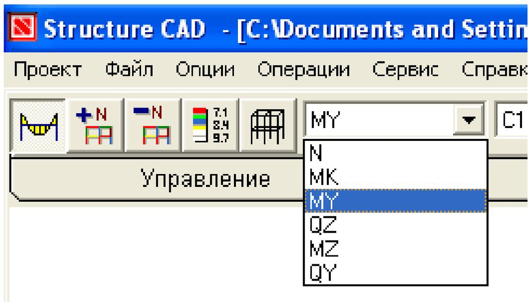
Рисунок 3.16 – Панель SCAD для выбора отображаемых внутренних усилий
