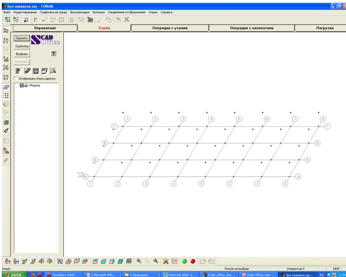
Рисунок 4.7 – Координационная сетка в препроцессоре Форум
