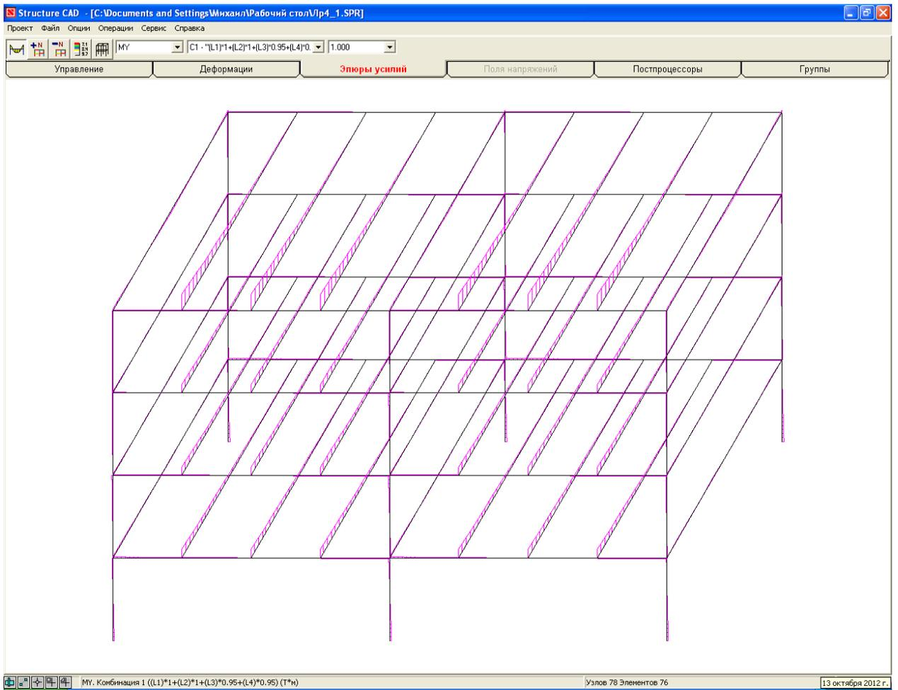
Рисунок 3.18– Эпюра  $M_Y$  в элементах пространственной рамы
