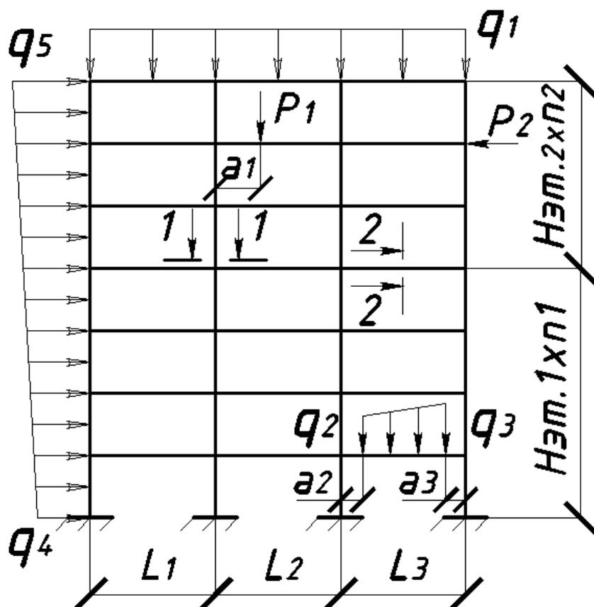
Рисунок 1.1 — Расчетная схема к лабораторной работе №1
