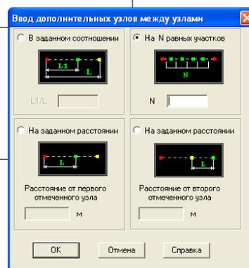
Рисунок 3.11 – Диалоговое окно SCAD для ввода дополнительных узлов между узлами
