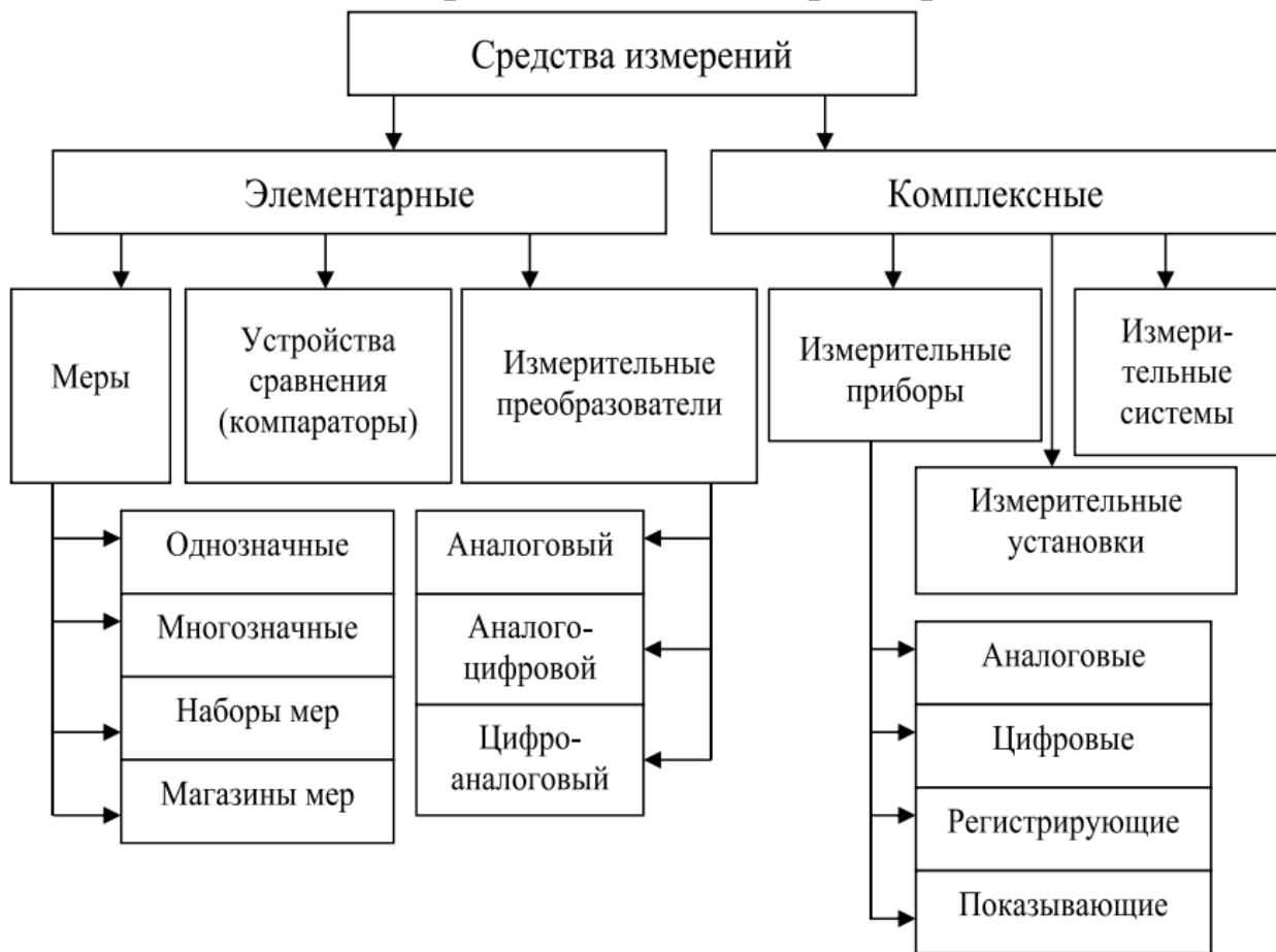
Рисунок 1 – Классификация средств измерения по техническому назначению
