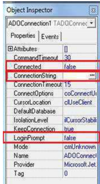
Рис. 2. Настройка свойств объекта ADOConnection1
