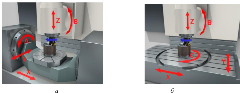
Рис. 12 Пятикоординатные фрезерные обрабатывающие центры
