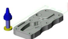
Рис. 12.16. Обработка торца (Face). Основными параметрами для этой стратегии являются шаг между проходами фрезы и угол обработки
