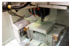
Рис. 7.2. Подача СОЖ в зону резания
