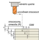
Рис. 8.6. Схема цикла прерывистого сверления
