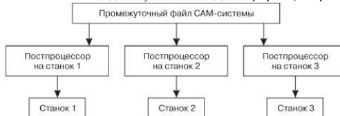
Рис. 12.28. Схема получения УП для конкретного комплекса «Станок – система ЧПУ»
