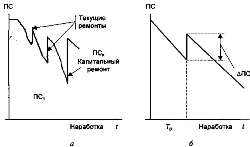
Рис. 2.1. Фактическое (а) и принятое (б) изменение потребительских свойств в процессе эксплуатации машин и оборудования
