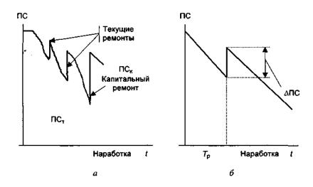
Рис. 2.1. Фактическое (а) и принятое (б) изменение потребительских свойств в процессе эксплуатации машин и оборудования
