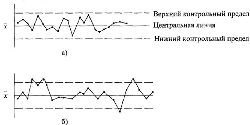
Рис. 5 Примеры контрольных \bar{X} -карт: а) управляемое состояние процесса; б) неуправляемое состояние процесса
