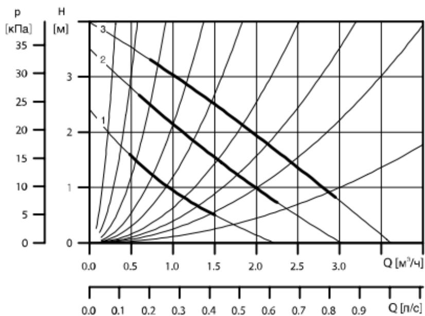
**Рис.П.4.5. Характеристики регулируемых электронасосов UPS 25-40 / UPS 32-40**
