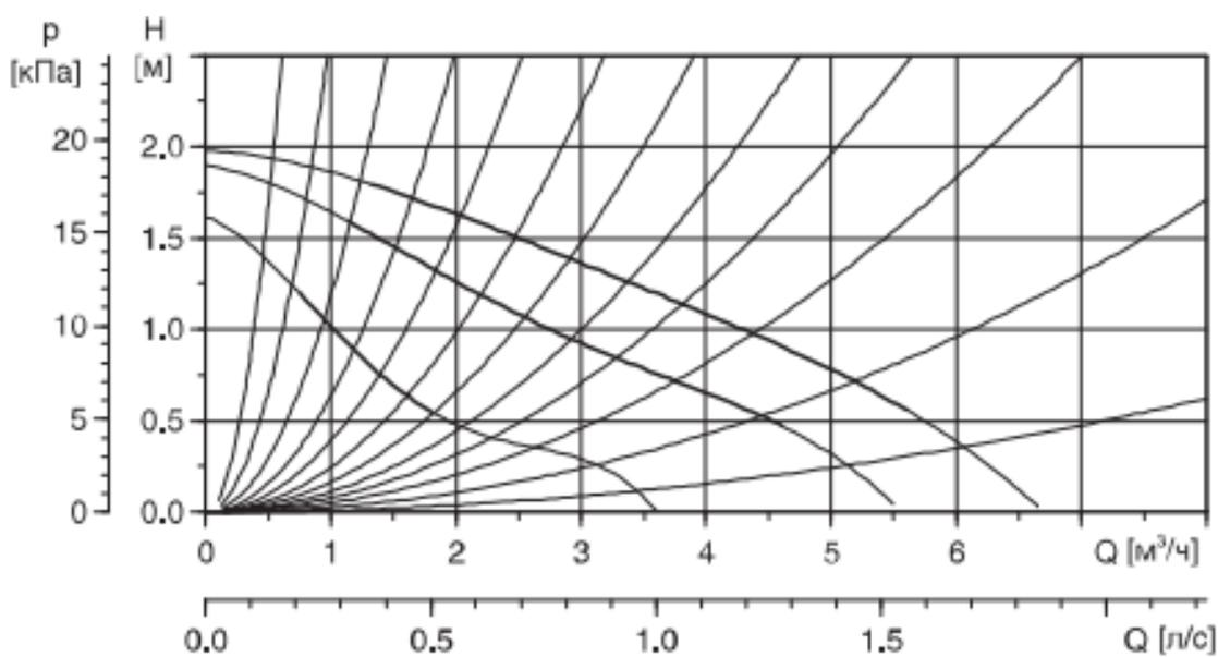
**Рис.П.4.4. Характеристики регулируемого электронасоса UPS 32-25**
