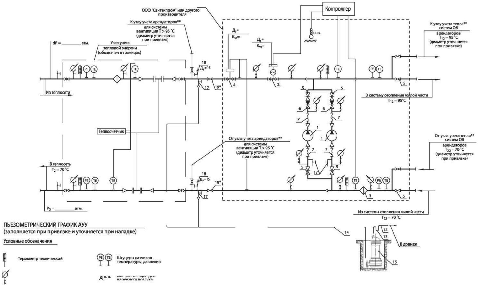
– Рис. 2 - Схема АУУ со смесительным насосом на перемычке между подающей и обратной
