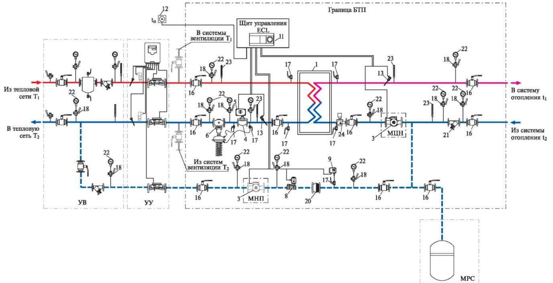
Рис. 1 - Схема АИТП при независимом присоединении системы отопления к тепловой сети (обозначение позиций см. прилож.1.)
