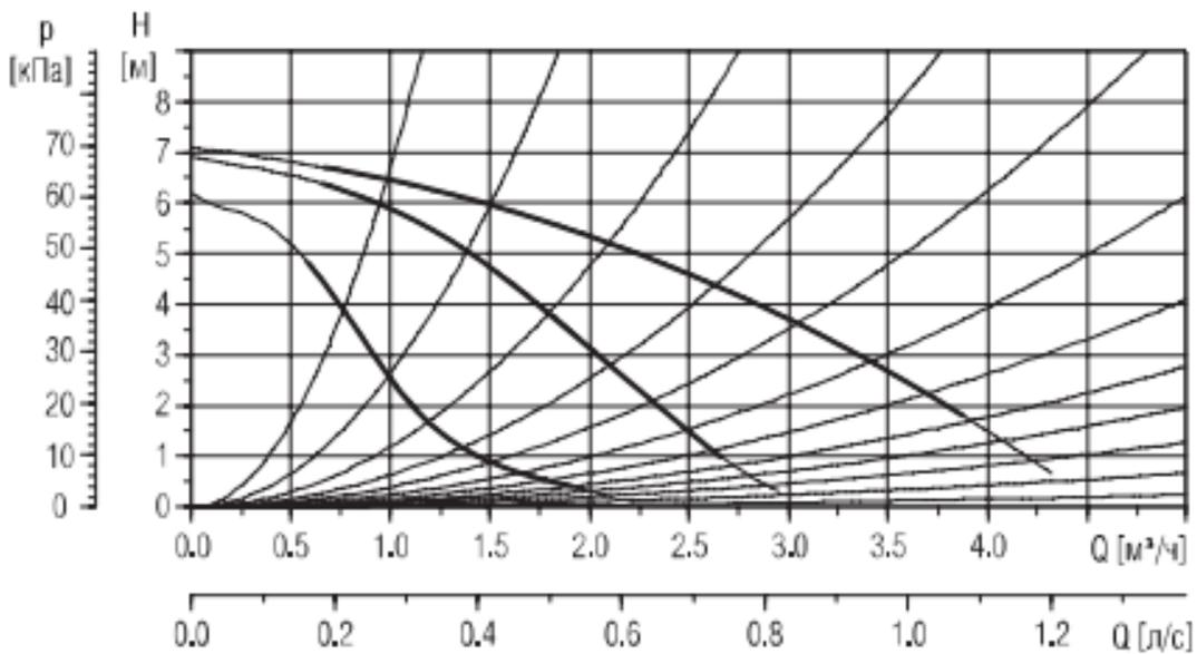
**Рис.П.4.10. Характеристики регулируемых электронасосов
