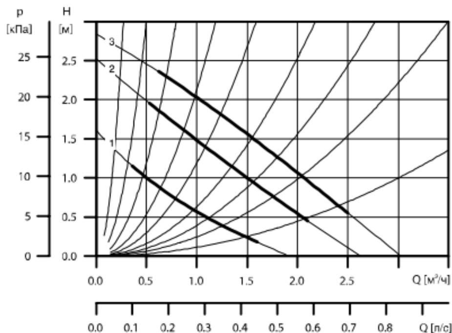
**Рис.П.4.2. Характеристики регулируемых электронасосов
