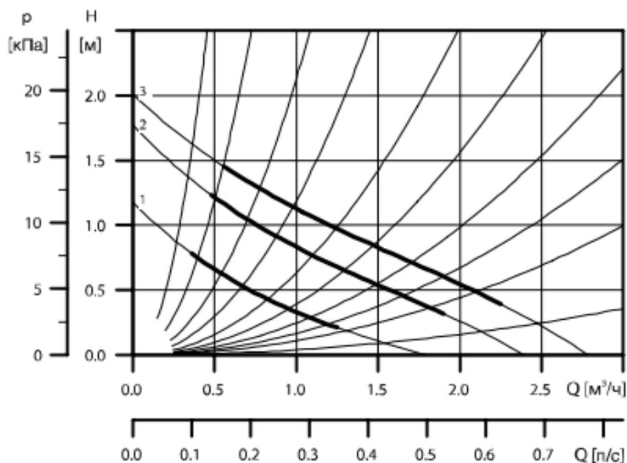
**Рис.П.4.1. Характеристики регулируемых электронасосов
