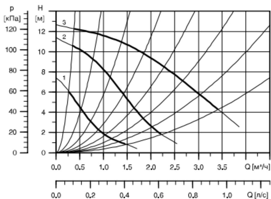
**Рис.П.4.13. Характеристики регулируемого электронасоса UPS 25-125**
