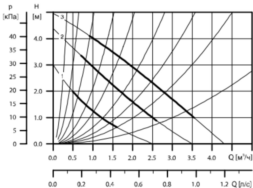
**Рис.П.4.6. Характеристики регулируемых электронасосов UPS 25-50 / UPS 32-50**
