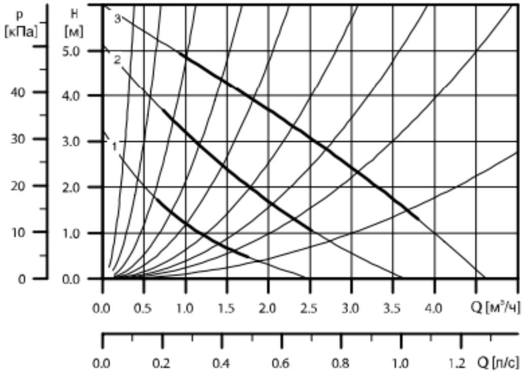
**Рис.П.4.9. Характеристики регулируемых электронасосов
