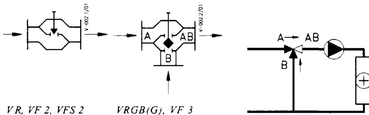
Рис. П.5.1. Принцип работы регулирующих клапанов.
