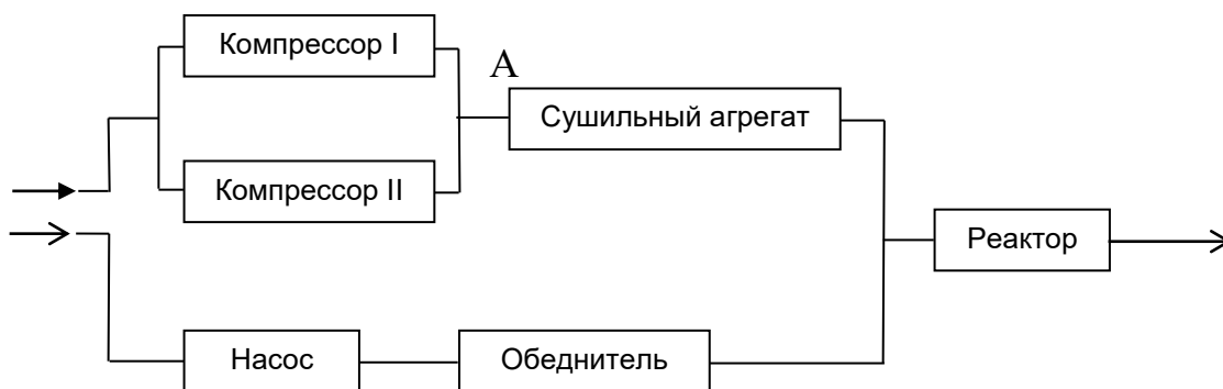
Рисунок 3 - Структурная схема химического реактора
