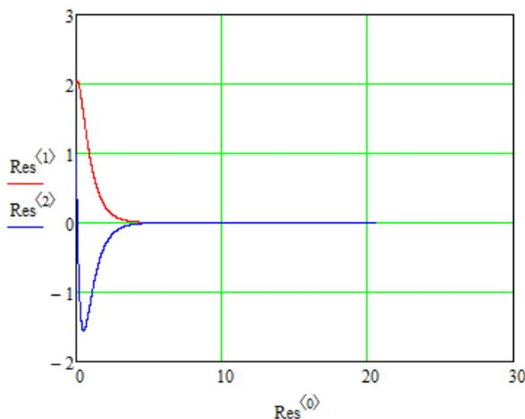
Рисунок 5 Временные зависимости  $y(t)$  и  $\dot{y}(t)$ , аппроксимирующие решение системы ОДУ
