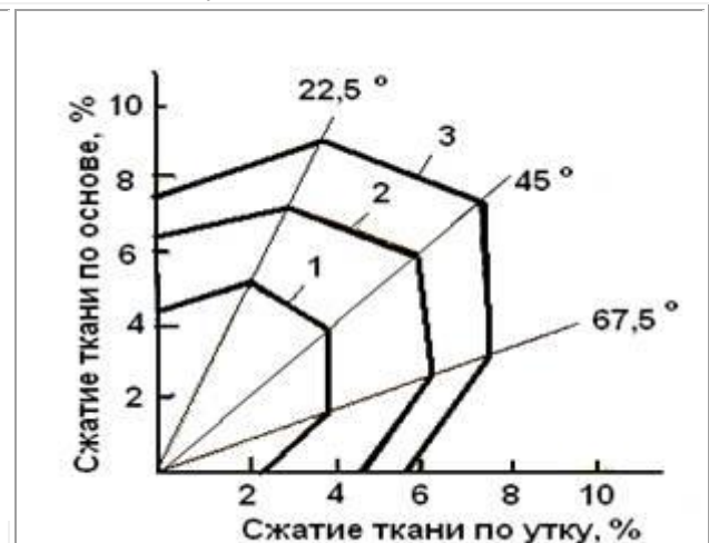
Рис. 2. Векторная диаграмма сокращения размеров ткани при суживании в различных направлениях: 1, 2, 3 — число циклов суживания
