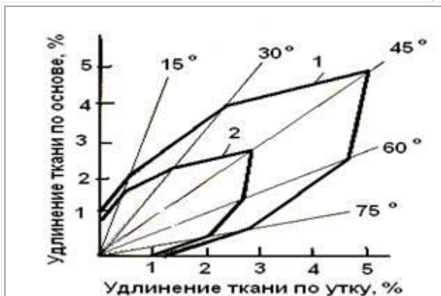
Рис. 1. Векторная диаграмма изменения удлинения ткани при приложении нагрузки 1 даН в различных направлениях: 1 — чистшерстяной костюмной; 2 — полушерстяной костюмной
