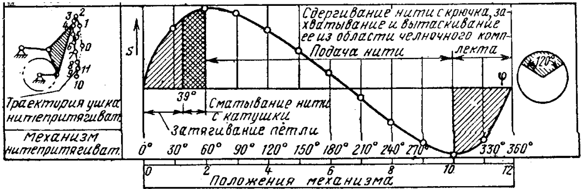
Рис. 9.4. Типовой закон движения исполнительного звена механизма нитепритягивателя
