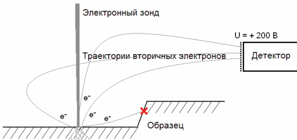
Рис. 5. Роль потенциала сетки Фарадея в детекторе Эверхарта-Торнли
