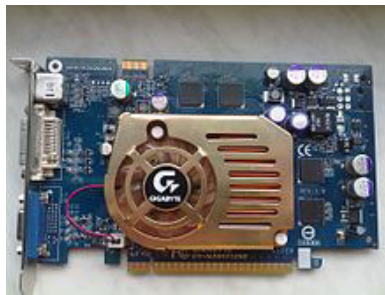
Рисунок 21. Видеокарта Nvidia GeForce 6600GT (производитель Gigabyte).
