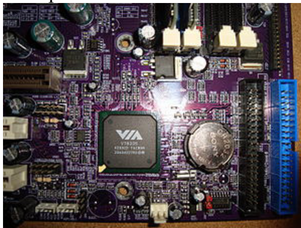
Рисунок 17. Южный мост VIA 8235.
