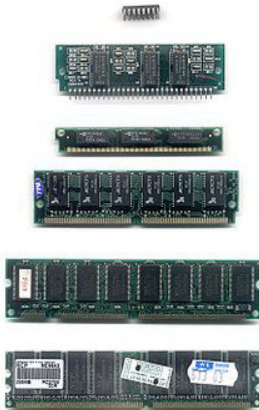
Рисунок 18. Эволюционное развитие конструкции модулей памяти, используемые в качестве ОЗУ компьютера. Сверху вниз: DIP, SIPP, SIMM 30 pin, SIMM 72 pin, DIMM, DDR DIMM.
