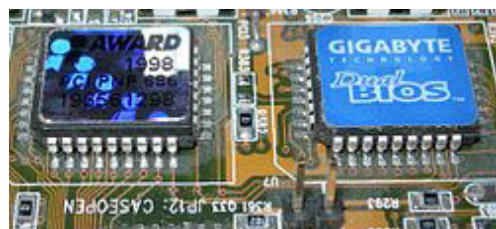
Рисунок 22. Основная и дублирующая микросхемы ПЗУ материнской платы фирмы Gigabyte. На ПЗУ содержится код BIOS, созданный фирмой Award.
