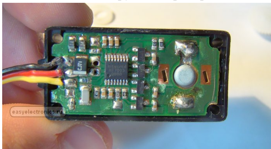
Рис. 2.2 Внешний вид схемы управления сервопривода
