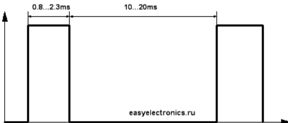
Рис. 2.3 Диапазон изменения ширины и длительности импульса
