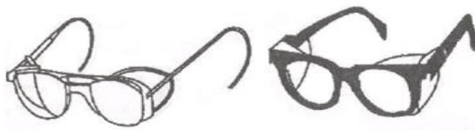
Рисунок 8 - Модели открытых очков для защиты глаз а) с полужитками; б) со съёмными щитками
