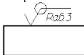
Рис 16. Обозначение одинаковой шероховатости поверхностей образующих замкнутый контур
