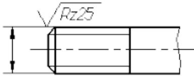
Рис 12. Пример обозначения шероховатости наружной резьбы
