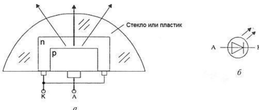
Рис.45 Схематическое изображение структуры светодиода и его УГО
