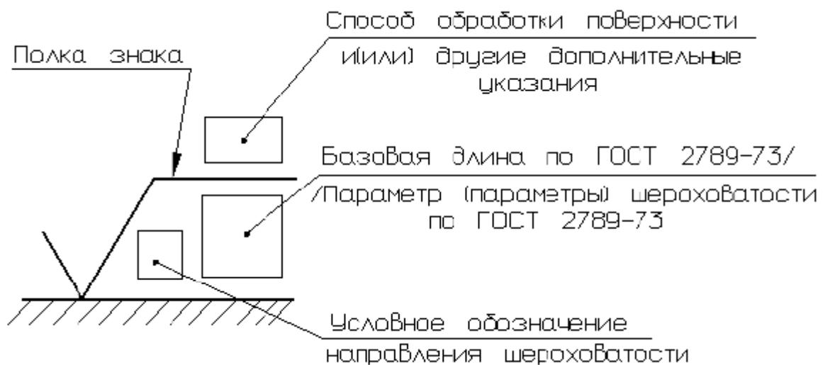
Рис 5. Структура обозначения шероховатости поверхности
