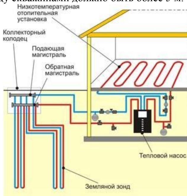
Рис. 7. Схема расположения земляного зонда
