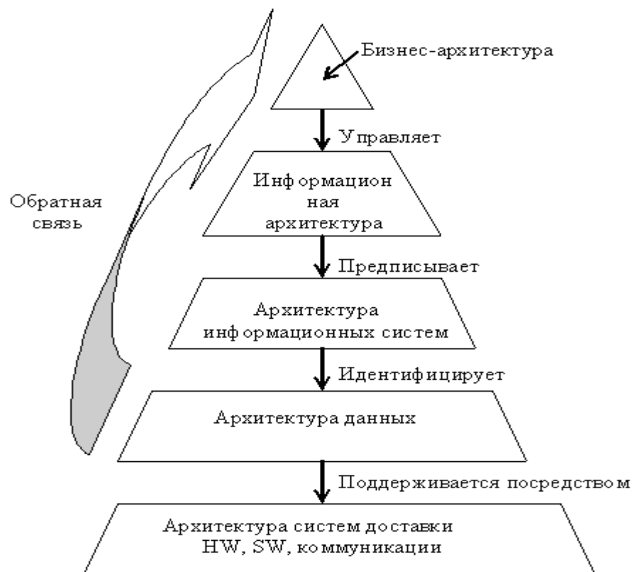
Рисунок 1- Схема архитектуры компьютеризированного предприятия по NIST (HW-hardware-аппаратное обеспечение, SW-software-программное обеспечение)
