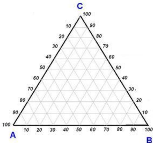
Рисунок 2 – Треугольник Гиббса- Розебома для изображения состава трехкомпонентных систем
