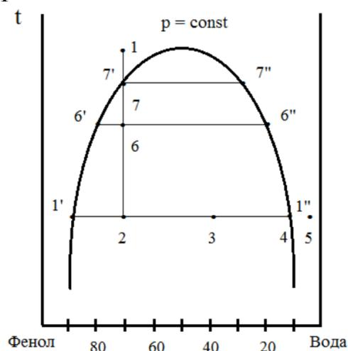
Рисунок 1 - Схема диаграммы состояния фенол – вода
